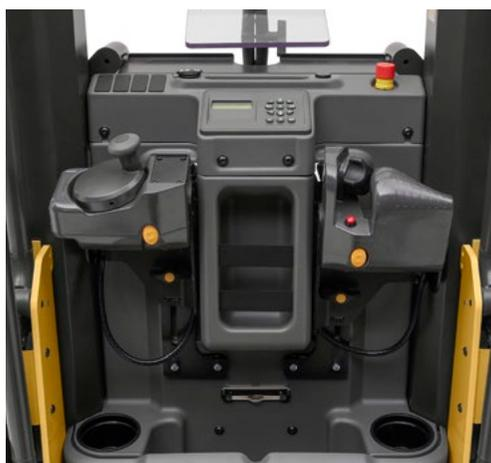
La più recente interfaccia utente colloca la mano destra del conduttore in una situazione anatomica ideale, su una unità di controllo con posizione regolabile. Oltre a controllare accuratamente le funzioni del carrello, supporta saldamente e comodamente questa mano, lasciando la sinistra libera di usare il volante Midi.
