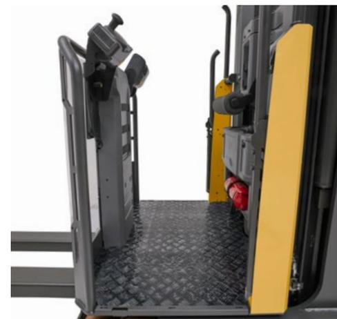
Il tappetino ammortizzato, ad elevato attrito, ricopre il sensore di rilevamento presenza sotto l'intera pedana. Il funzionamento è ammesso da qualsiasi posizione in piedi. La zona di accesso è velocemente attraversabile e non contiene ingombri che possono far rischiare di inciampare, principalmente grazie all'assenza del tradizionale 'pedale di presenza uomo a bordo'.
