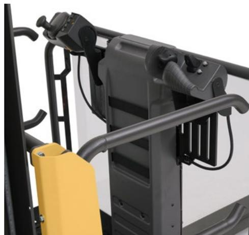
La moderna interfaccia, di facile impiego, dispone di una unità di controllo per la mano destra che fornisce forma anatomica, regolazione della posizione, aderenza e sostegno eccellenti, per una operatività comoda e precisa. Mentre, la mano sinistra resta fermamente sul volante Midi.
