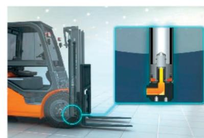
► dispositivo tampone di abbassamento
