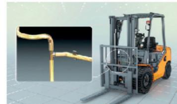
conduttura del montante
